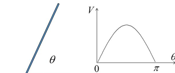
对于类似这两个例子的物理体系，可以看到其质心在平衡点和非平衡点的相对位置决定了体系的稳定性。若非平衡点处质心的位置高于平衡点质心位置则为稳定平衡，反之则为非稳定平衡，这也是因为质心位置的高低决定了重力势能大小的缘故。常见的玩具不倒翁就是调整了玩具中的质量分布，使得不倒翁倾斜时质心位置变高，从而其平衡成为稳定平衡。
